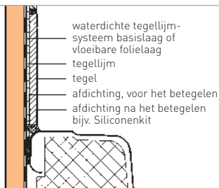
Afbeelding 27: Wandaansluitingen van douche of ligbaden (verticale doorsnede). Aansluiting aan FERMACELL enkel beplatede montagewand bijvoorbeeld 1 S 11
